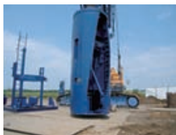
拡底バケットの作動状況
