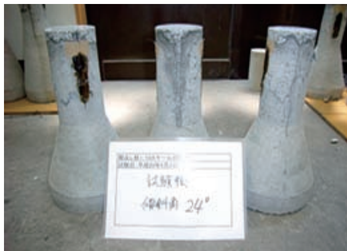
1/10モデル破壊実験供試体状況(傾斜角24°)
