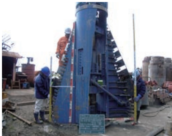
傾斜角20°用に改造したバケット(SY-1023バケット)
